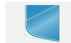
Thermosoudure entre panneaux et remontée en plinthe du revêtement de sol souple
